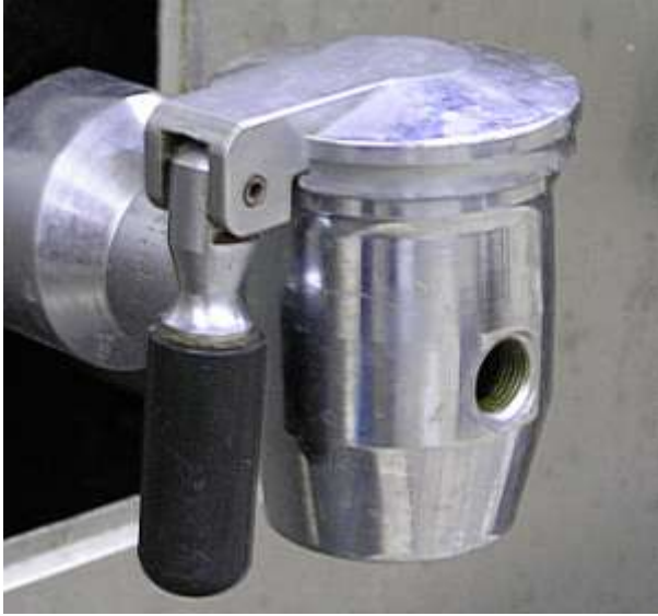
Слика бр.1: Славина за испуст хране
